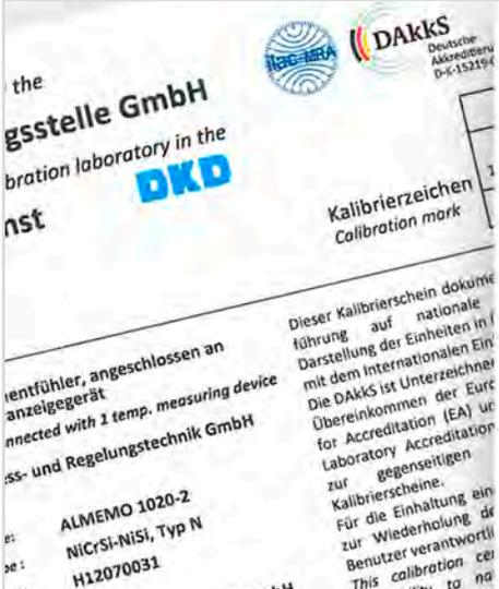
**Kalibriergegenstand** 1 Thermoelementfühler NiCrSi-NiSi, Typ N, Ø 6 mm Länge 760 mm, angeschlossen an ein Temperaturanzeigergerät ALMEMO 1020-2, Serien-Nr. H12070031
